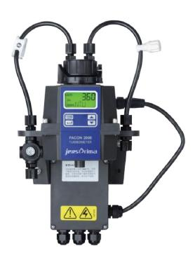
PACON 2000流通式浊度分析仪是为工业和市政水处理应用而设计的在线产品,90°散射光法,满足美国EPA180.1规定,广泛应用于自来水厂、污水厂和水处理领域。
